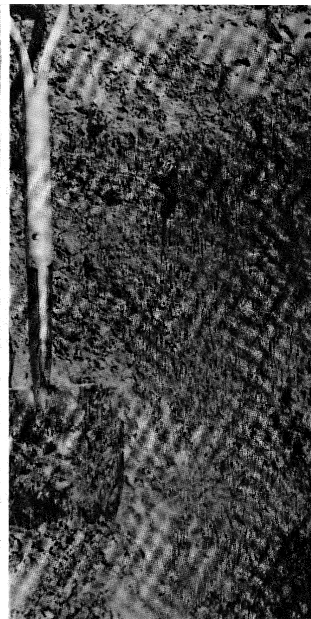
Pradera Parda máxima con horizonte A masivo y claro, y horizonte B, oscuro y fuertemente estructurado.
